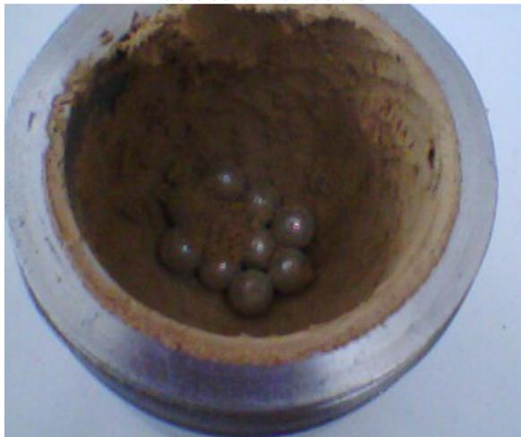
Figura 3.6.1 d) Muestra finamente molida
